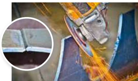
ตัวอย่างการบากชิ้นงานก่อนทำการเชื่อม
